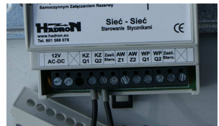
Rys. 3 Sposób przyłączenia przewodów pod zaciski sterownika
